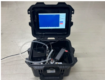
図3 試作した静電捕集型アルファ線放出核種測定機器
